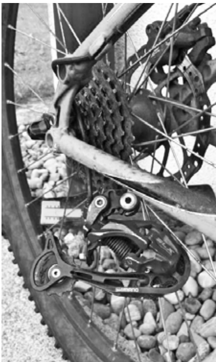
Mutwillig eingetretener Kettenwechsler an einem Mountainbike
